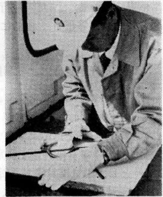
写真(上) 測量船上で六分儀による測角
