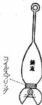
図-6・1 スナッパー型採泥器
