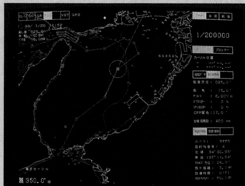
内航近代化船の電子参考図機能の表示例（大阪湾）
