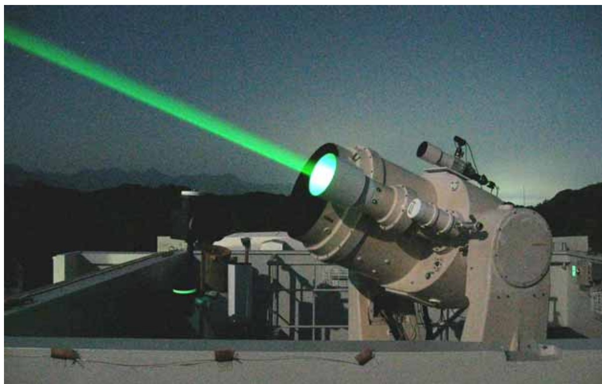
写真2 人工衛星レーザー測距装置
