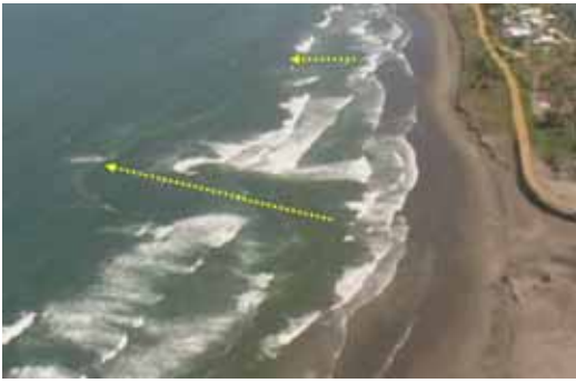
図4 凹地形部で発生した離岸流 (汀線が陸側に後退している箇所前面)
