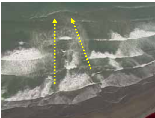
図7 砕波形状と気泡で推定する離岸流
