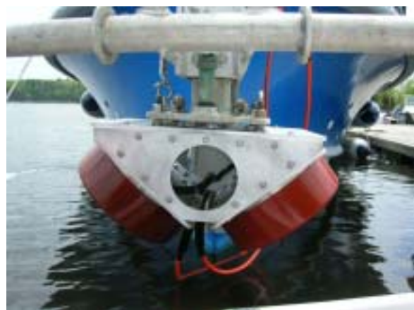
写真2 船首に取り付けられた EM3000D ソナーヘッド
