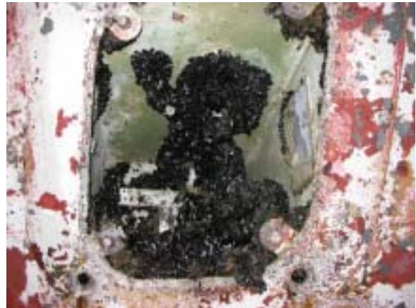
写真4 シーチェスト内生物汚損の実態
