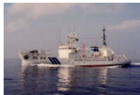
測量船「天洋」総トン数：430トン 主要寸法 (m):(全長×巾×深) 56.0×9.8×4.8m
