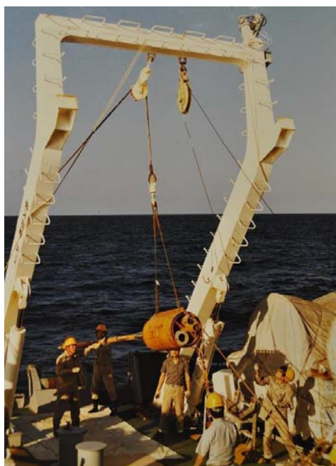
写真1 地殻熱流量計付柱状採泥器の海中への投入作業
