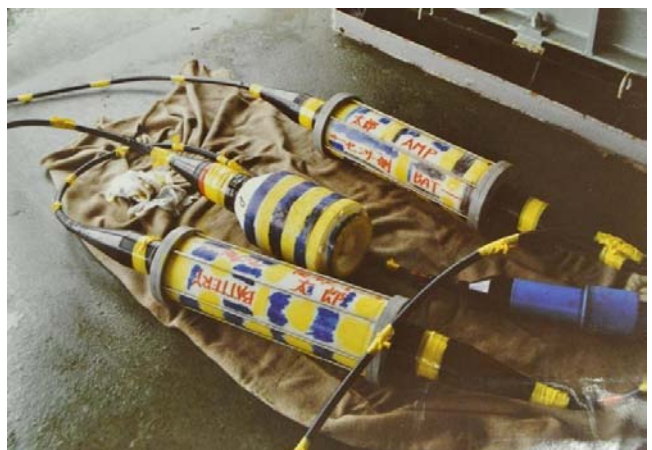
写真5 3センサー型プロトン磁力計の曳航部。手前よりバッテリー部、センサー部、アンプ部
