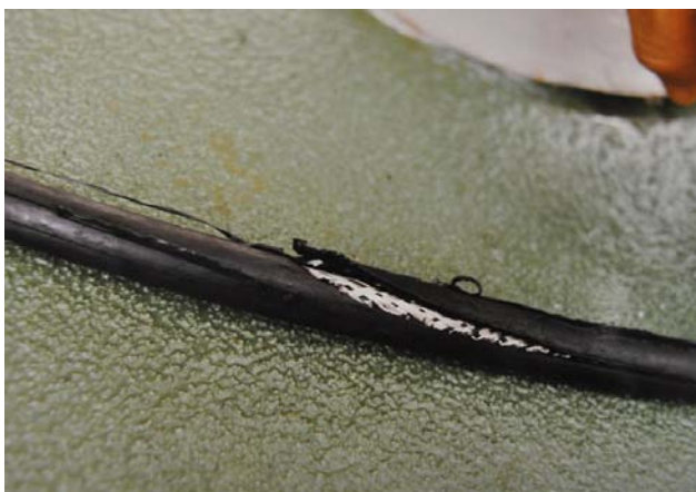
写真3 サメに噛まれたプロトン磁力計のケーブル
