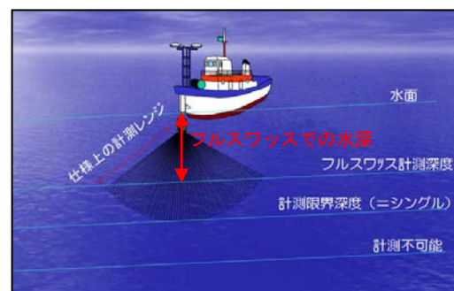
図 2 計測レンジと計測範囲の関係
