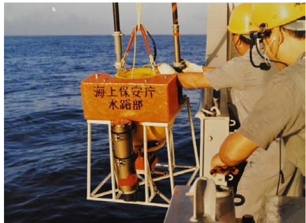
写真2 海中に投入される海底磁力計
