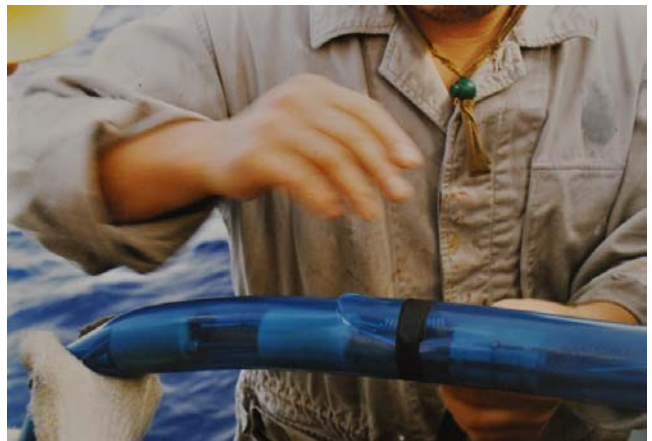
写真4 サメに噛まれた音波探査装置のストリーマーケーブル
