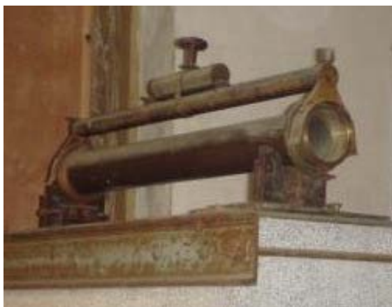
写真 3 望遠鏡の調整をするための器具である集心儀（国立天文台提供）
