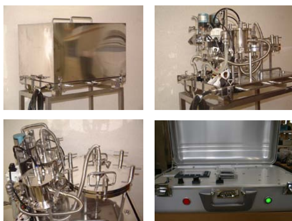
写真1 濃縮装置本体とコントローラ外観
