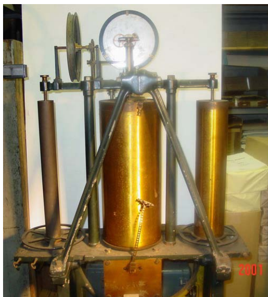
写真 1 海洋情報部で保存しているケルビン型験潮儀
