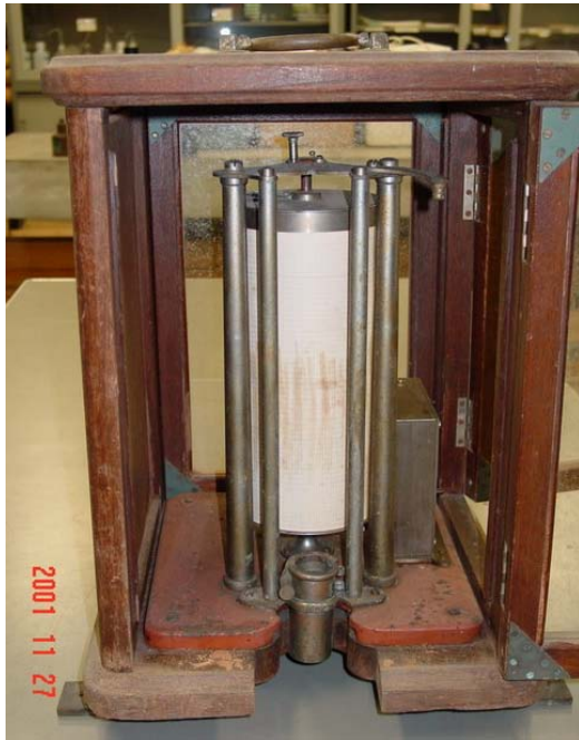
写真2 海上保安学校で保存している本多博士考案の水路部型験潮器の記録部
