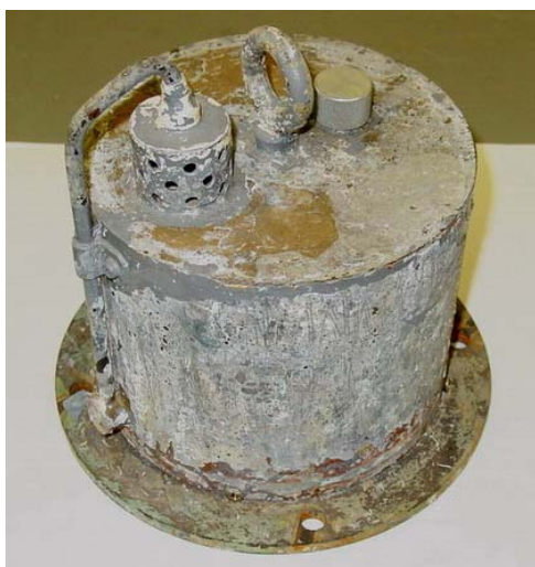
写真3 海上保安学校で保存している水路部型験潮器の沈鐘。中には、ゴム・ペローズが入っている。
