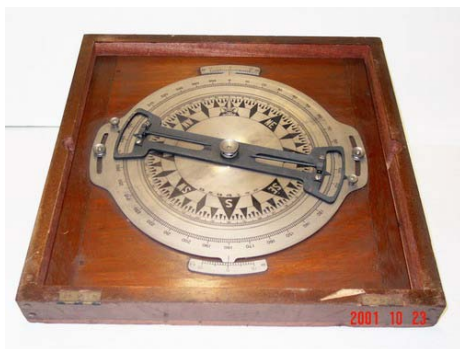
船の位置を求めるため、陸の物標の方向角を測定するダム・カード。
