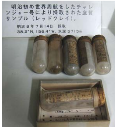
写真4 海洋情報部所蔵のチャレンジャー号がドレッジした底質試料
