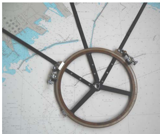
写真2 中型の三杆分度儀 大・中・小の3種類がある
