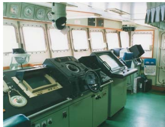
写真5 測量船「海洋」のECDIS
