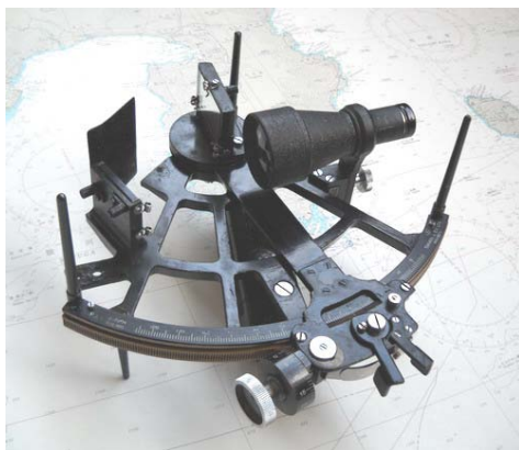
写真 1 倍率 3 倍の望遠鏡を装着した状態の航海用六分儀
