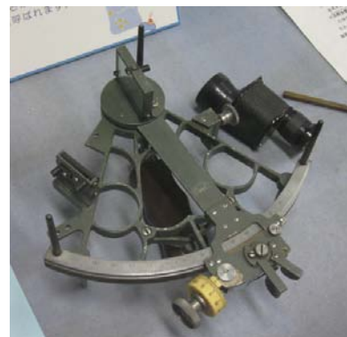
写真6 海洋情報資料館で展示されている測量用六分儀 航海用六分儀より軽量に作られている
