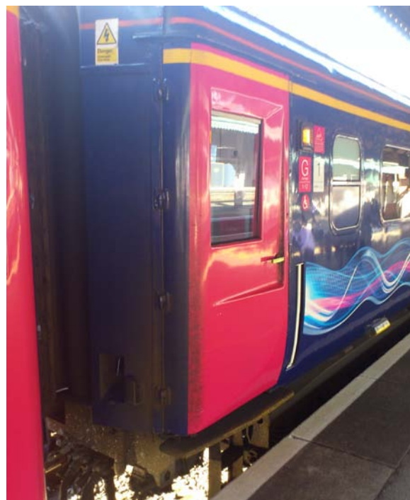
写真2 外側からしか開けられない列車の扉
