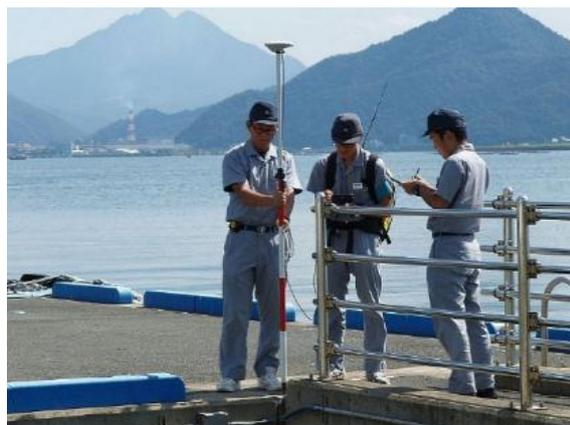
RTK-GPSによる岸線測量
