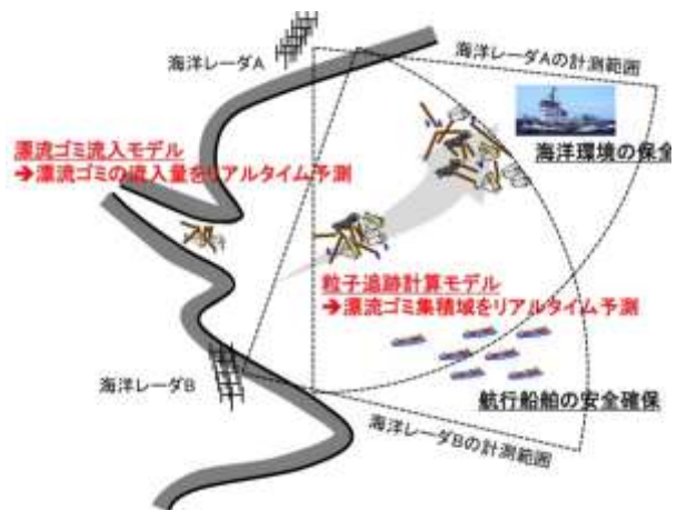
図2 漂流ゴミ集積域予測システムの概念図
