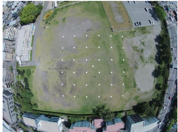
写真 16 写真の歪確認作業中の様子 (Phantom2+GoPro による静止画像の歪確認画像)
