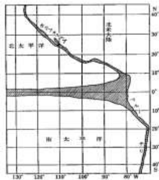
図4 吉田耕造(1922-78)と沿岸湧昇域と赤道湧昇域の つながり図 (Yoshida, 1967)。 斜線海域が湧昇・潜流域。海面が風によって 引っ張られ、それを補償するように海水が流 れる。漁獲生産力、海面水温は大気にも影響 し大規模気候変動に影響する。
