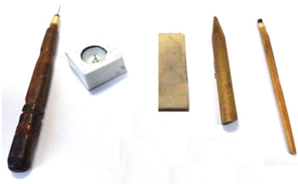
図2 点突針、墨壺、オイルストーン、削刀2種
