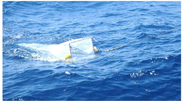
写真3 マイクロプラスチック採集のためのニューストンネット曳航の様子1
