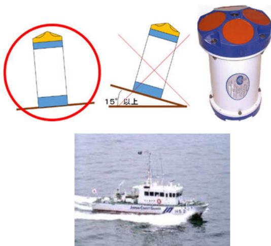
図7 超音波流速計と測量船くるしま
