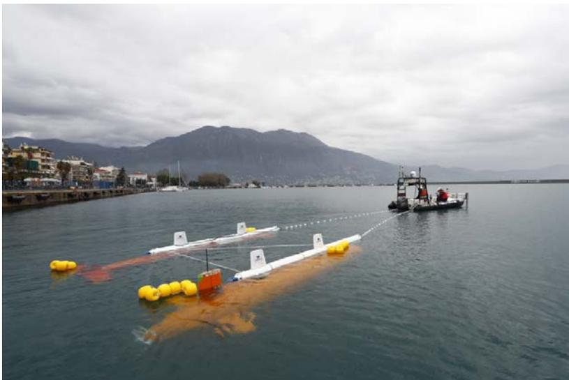
図4 地中海でのASVによるAUV2機曳航
