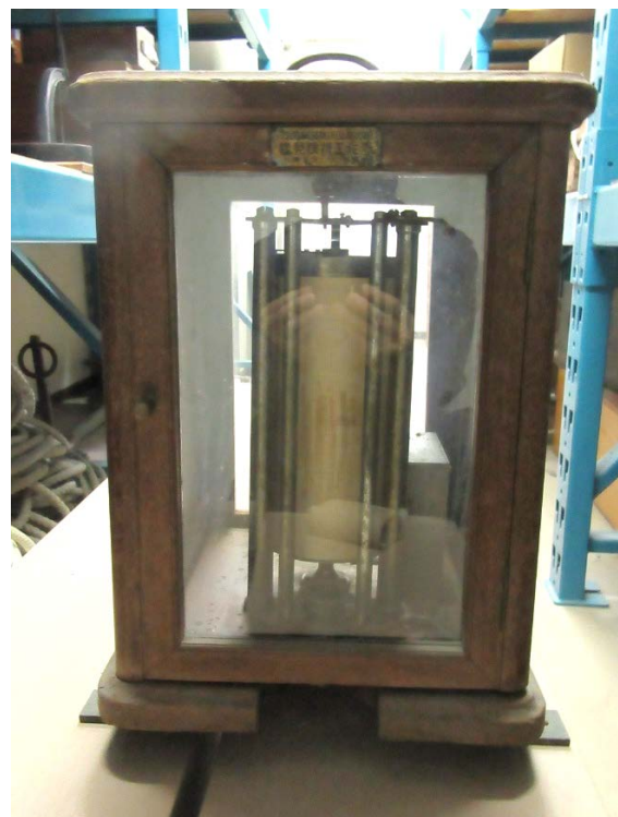
写真 2 海上保安学校に保管されている本多式驗潮器の記録部。
