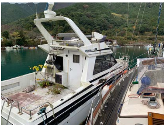
沖アンカーのモーターボートに横抱き係留
