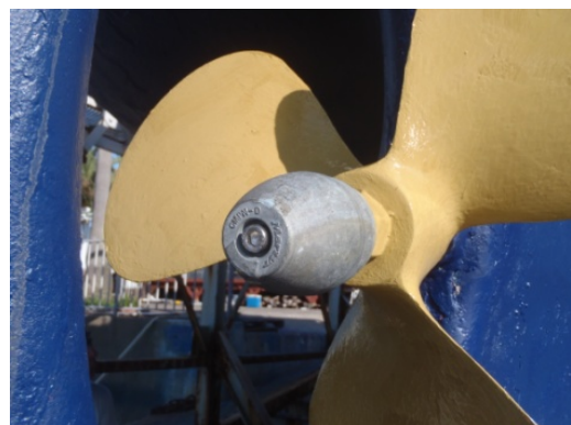
プロペラに取り付けた保護亜鉛
