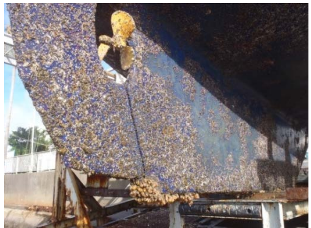
船尾付近の海洋生物付着状況
