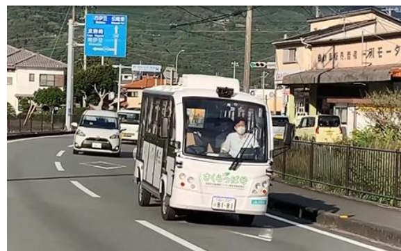
図-10 点群データを活用した自動走行実験
